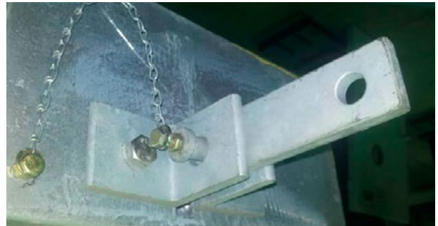
Bloqueo mecánico de cadena cinemática
