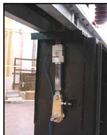
Medición de la fuerza Fm con celda de carga
