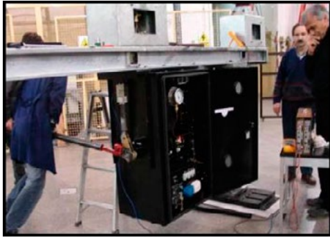
Aplicación de 1,5 Fm medida con celda de carga
