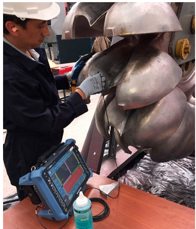
Figura 1. Inspección con el equipo de Ultrasonido Industrial OmniScan MX2 y personal técnico del rodete Pelton de la Central Hidroeléctrica Pucará con 82027 horas de operación.
