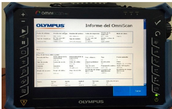
Figura 17. Informe obtenido luego de una Inspección con el OmniScan MX2, que puede ser impreso utilizando sus puertos o a través de la exportación del archivo a un PC.
