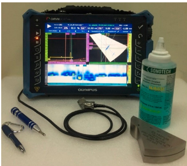
Figura 2. Detector de Defectos OmniScan MX2 Olympus Serie Nro. OMNI2-103549 y módulo PA con TOFD de 32:128 elementos.
