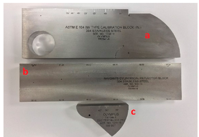
Figura 10. Bloques de referencia para calibración del equipo de ultrasonido. a) Bloque IIW tipo 1. b) Bloque NAVSHIPS. c) Bloque AWS.
