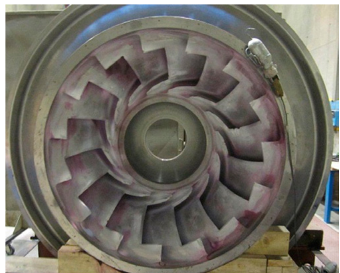
Figura 20. Extracción de zonas fatigadas y con defectología.
