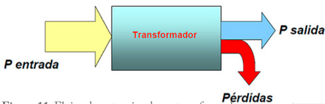
Figura 11. Flujos de potencias de un transformador.
