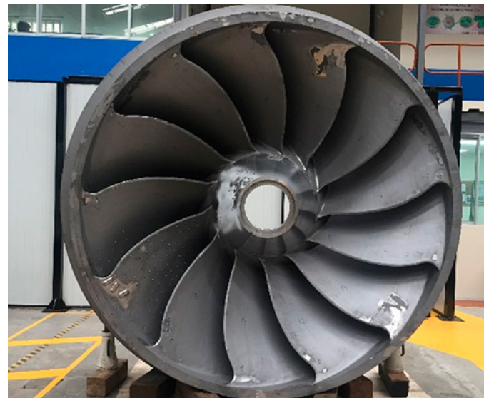
Figura 18. Rodete Francis Central H. San Francisco. Los álabes fijos deben ser inspeccionados y reparados.
