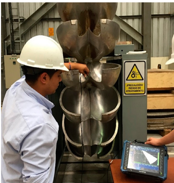
Figura 15. Inspección con UT por Arreglo de Fases, en los cangilones del rodete de la Central Hidroeléctrica Pucará.
