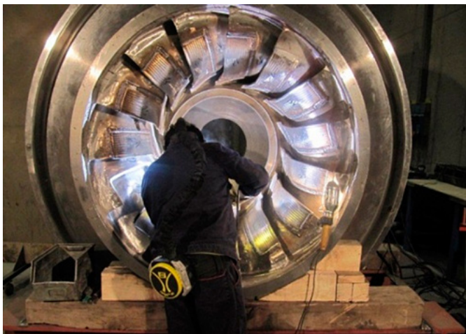
Figura 22. Soldadura de calces nuevos.
