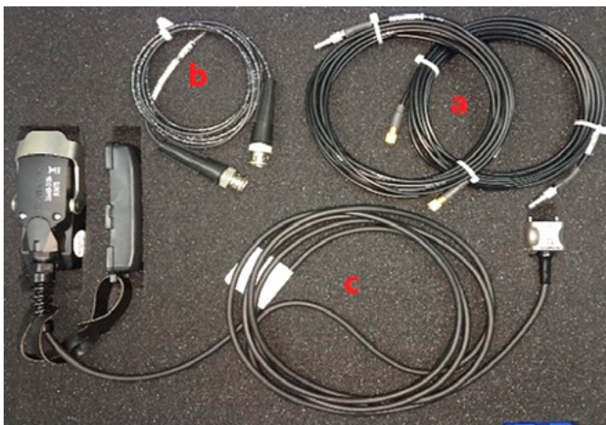
Figura 8. Cable coaxial utilizado para la inspección por ultrasonido a) Lemo 00 - microdot, b) BNC, c) PA.
