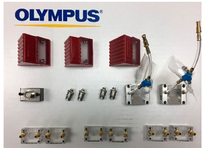
Figura 9. Zapatas y transductores de haz recto, haz angular para UT y para PA.
